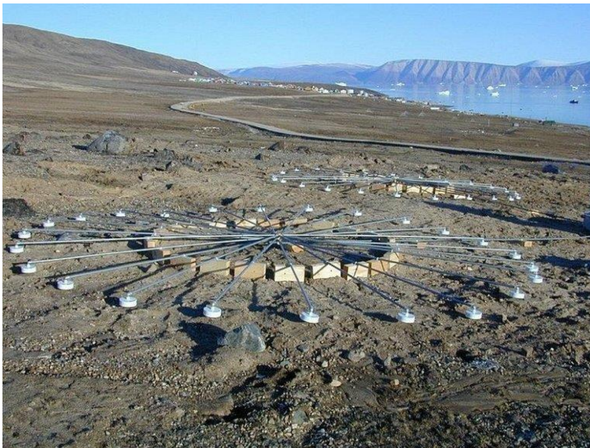
Фиг.2. Акустична група от инфразвукова станция IS18 в Гренландия.
