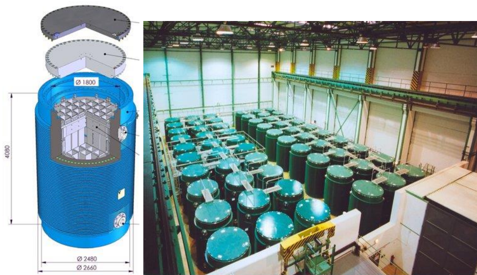
Фиг. 4. Контейнер за съхранение на отработено гориво тип CASTOR 440/84 и изградено дълговременно хранилище
