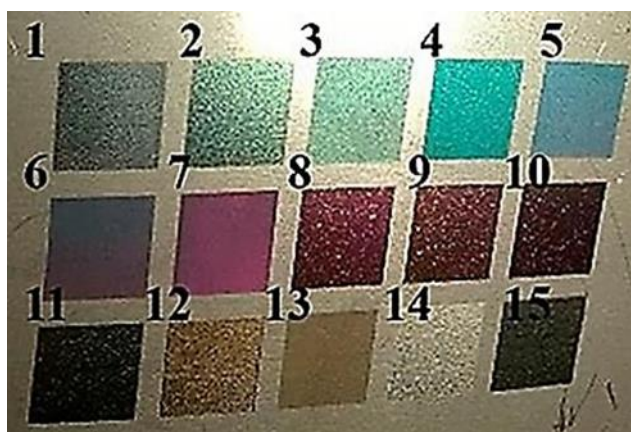
Фигура 8. Цветова палитра след 24-часово излагане на въздействието на околната среда в камерата за изпитване при температура 40\text{ }^{\circ}\text{C} и влажност 70%.
