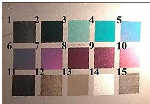
Фигура 6. Цветова палитра след 24-часово излагане на въздействието на околната среда в тестовата камера при температура - 40 °С и влажност 90%.
