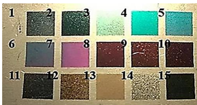
Фигура 5. Цветова палитра след 24-часово излагане на въздействието на околната среда в тестовата камера при температура -20 °C и влажност 70 %.
