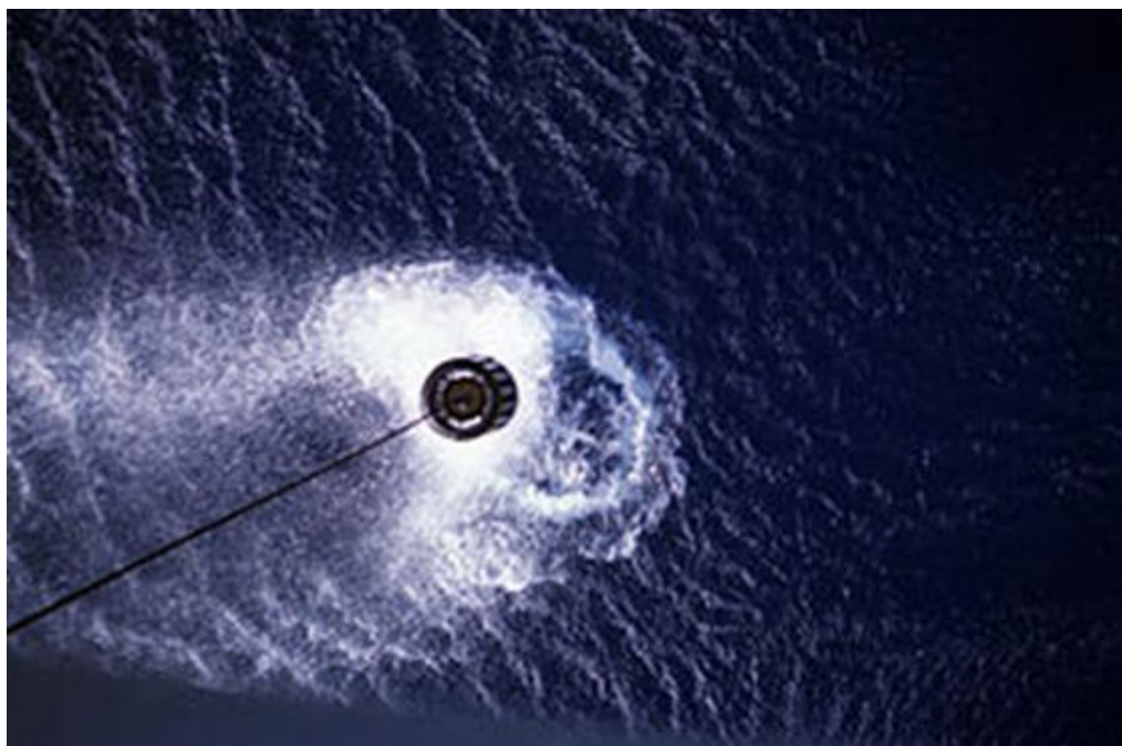
Фиг. 2. Военен сонар AN/AQS-13, повесен от хеликоптер SH-3 Sea King
