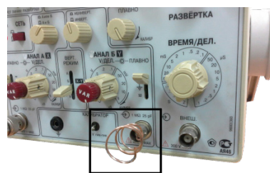
Рис. 5 Имитация рупорной антенны, подключенная к осциллографу
