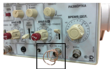
Рис. 5 Имитация рупорной антенны, подключенная к осциллографу
