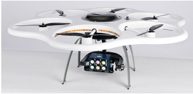
Рис.1. Гексакоптер с сельскохозяйственной цифровой камерой Tetracam (ADC)
