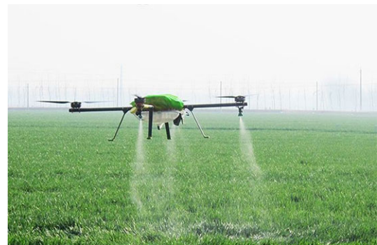
Рис. 3. Гексакоптер гексакоптер Agrofly TF1A распыляющий пестициды
