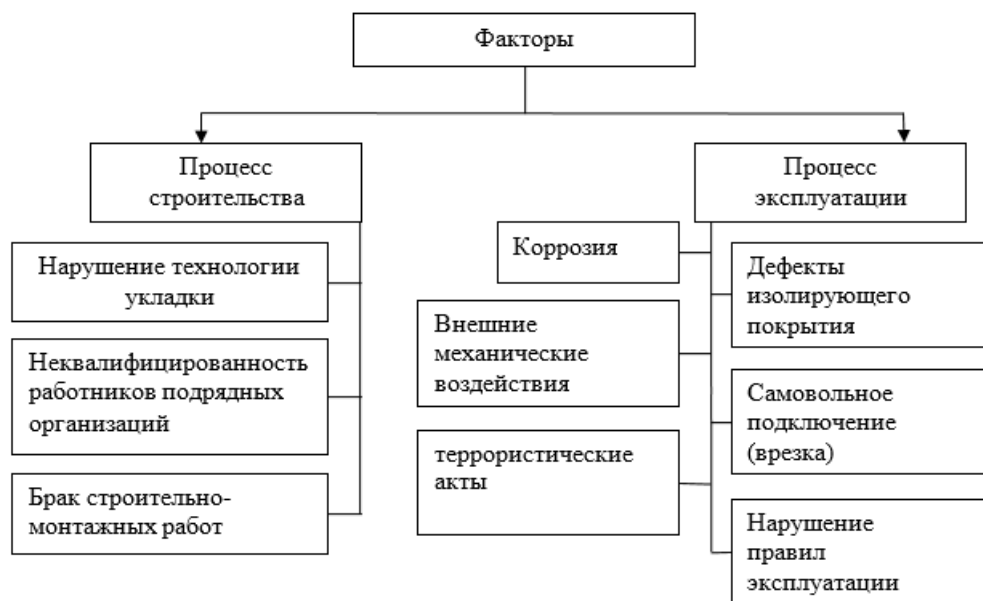
Рисунок 2 – Факторы, влияющие на техническое состояние нефтегазопроводов
