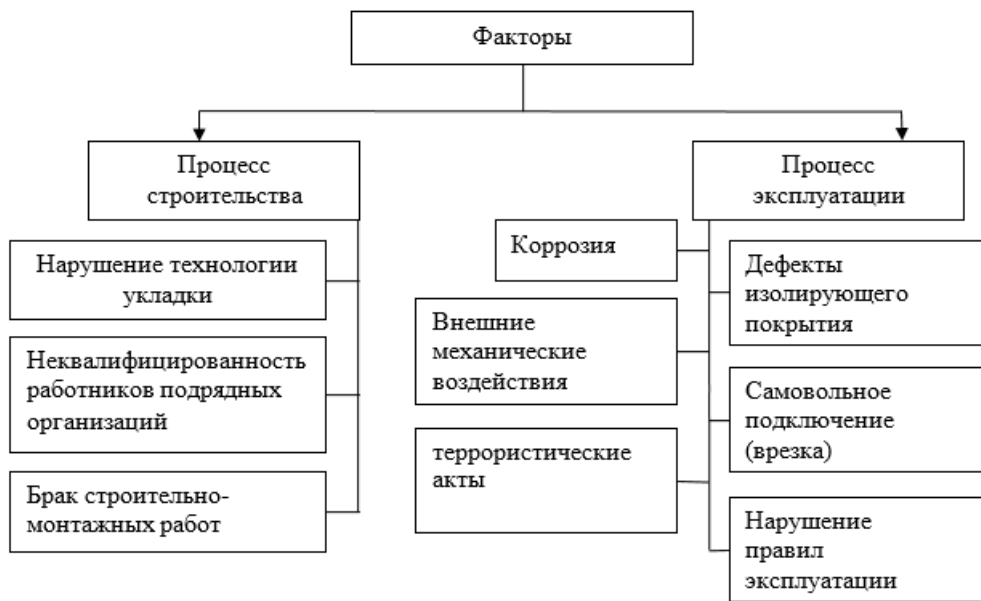
Рисунок 2 – Факторы, влияющие на техническое состояние нефтегазопроводов
