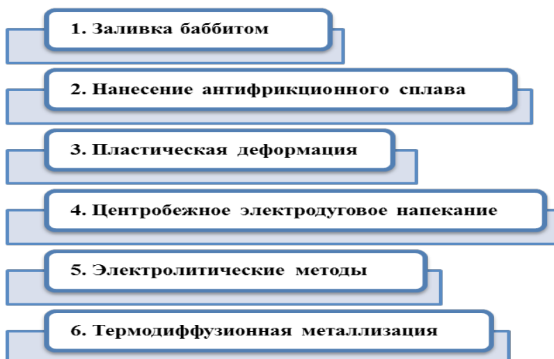
Рисунок 1. Методы восстановления деталей типа «втулка» из бронзы
