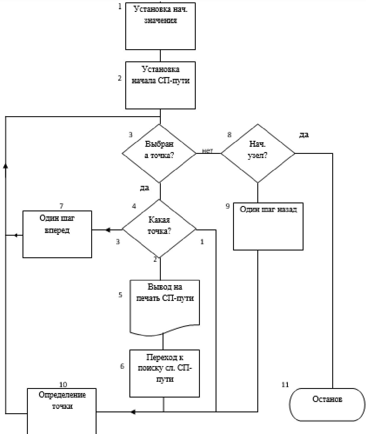
Рисунок. Структурная схема алгоритма поиска сигнальных путей между заданными узлами
