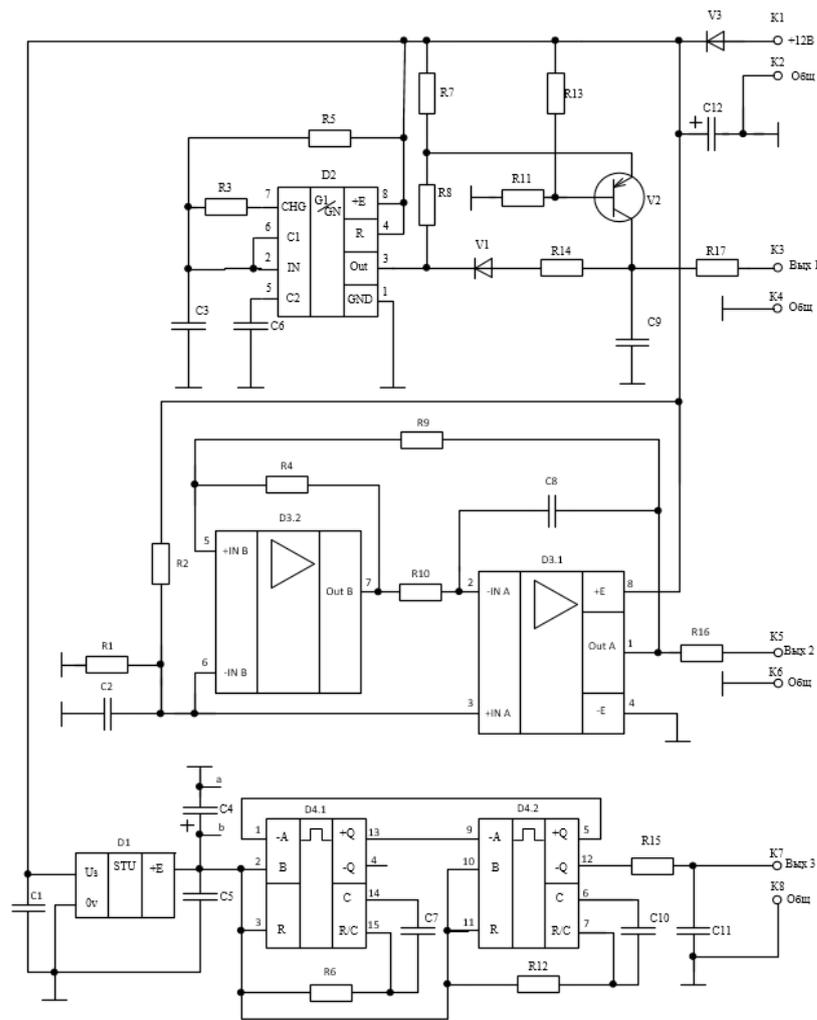
Цепи «а» и «б» соединить соответственно с конт. 8 и 16 микросхемы D4
