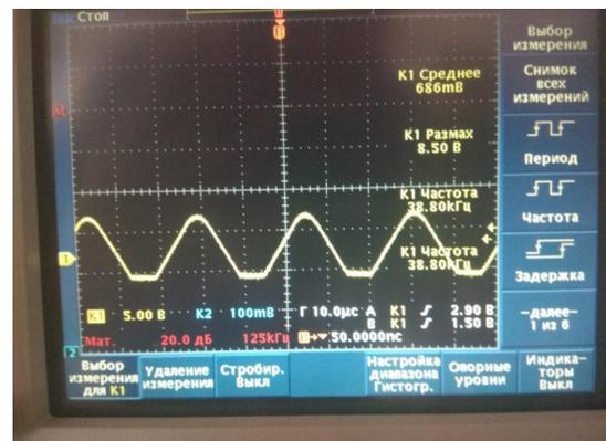
Рисунок 5 – Осциллограмма на выходе 2 ГПН
