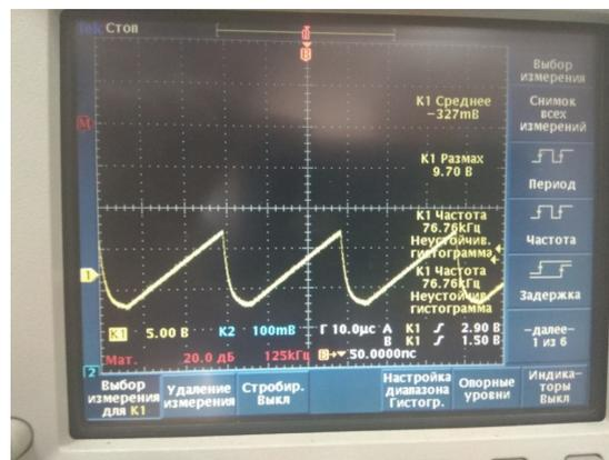
Рисунок 4 – Осциллограмма на выходе 1 ГПН
