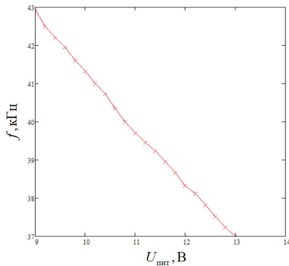
Рисунок 8 – Зависимость частоты от напряжения питания для ГПН на ОУ
