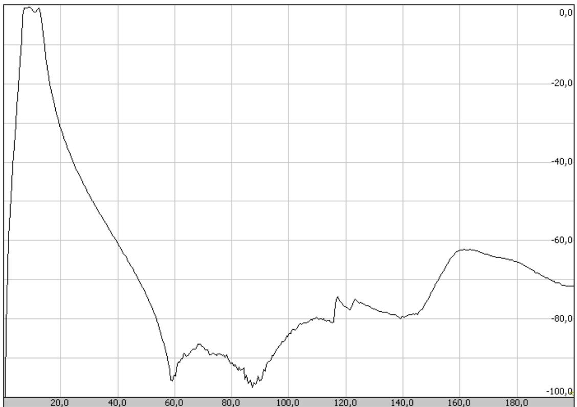
Рисунок 7 – АЧХ фильтра 7,5–12 МГц в полосе 0,3–200 МГц
