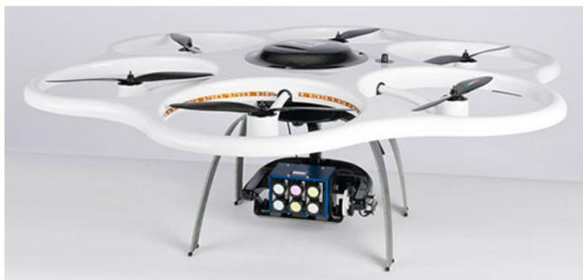
**Рис.1. Гексакоптер с сельскохозяйственной цифровой камерой Tetracam (ADC)**
