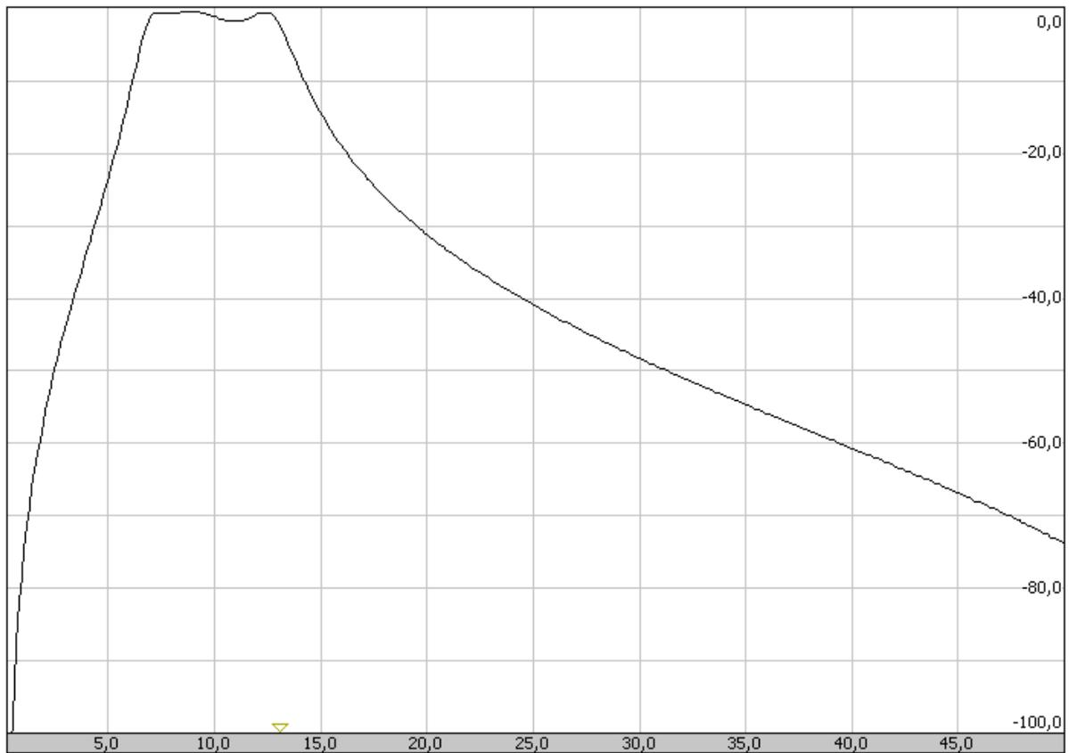
Рисунок 6 – АЧХ фильтра 7,5-12 МГц в полосе 0,3-50 МГц
