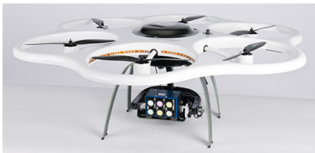
Рис.1. Гексакоптер с сельскохозяйственной цифровой камерой Tetracam (ADC)
