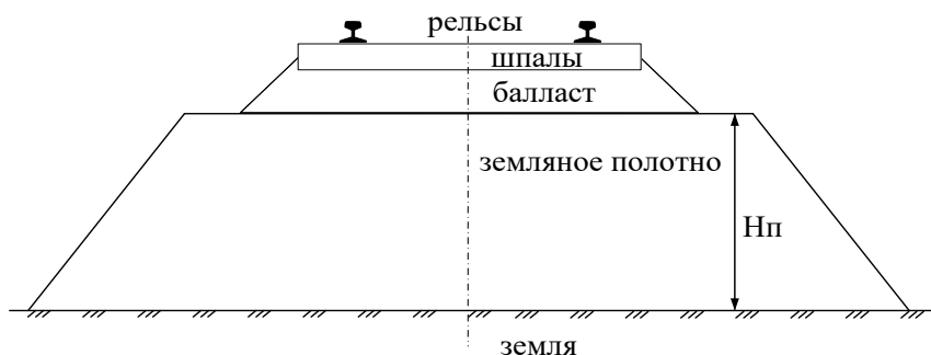
Рисунок 1 – Конструкция пути однопутной железной дороги
