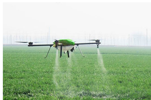
Рис. 3. Гексакоптер гексакоптер Agrofily TF1A распыляющий пестициды
