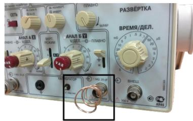
**Рис. 5 Имитация рупорной антенны, подключенная к осциллографу**
